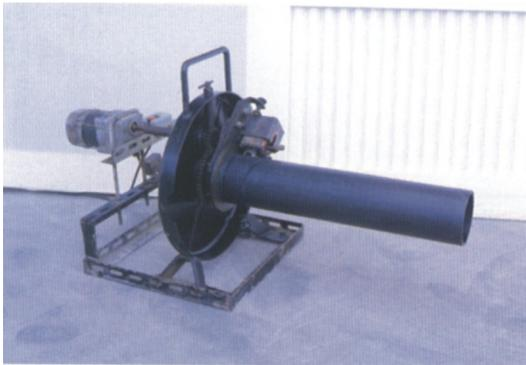
以專用的刮溝機於管端進行切齊及刮溝的工作
