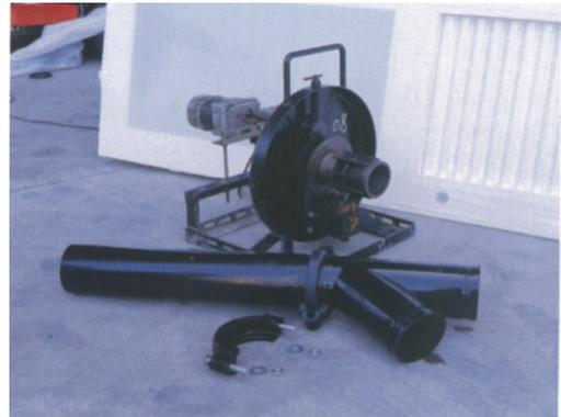
將止水橡膠先套入任一接合端，調整止水橡膠的位置，約貼於兩接合端元溝槽間
